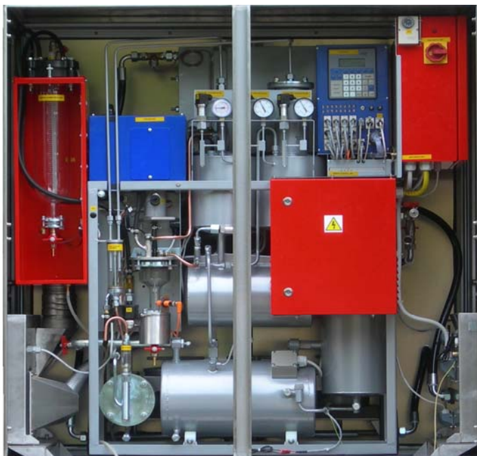
Vnitřní uspořádání Vakuového separátoru VS-06 (verze 2018) Stripping : odstraňování rozkladných plynů
