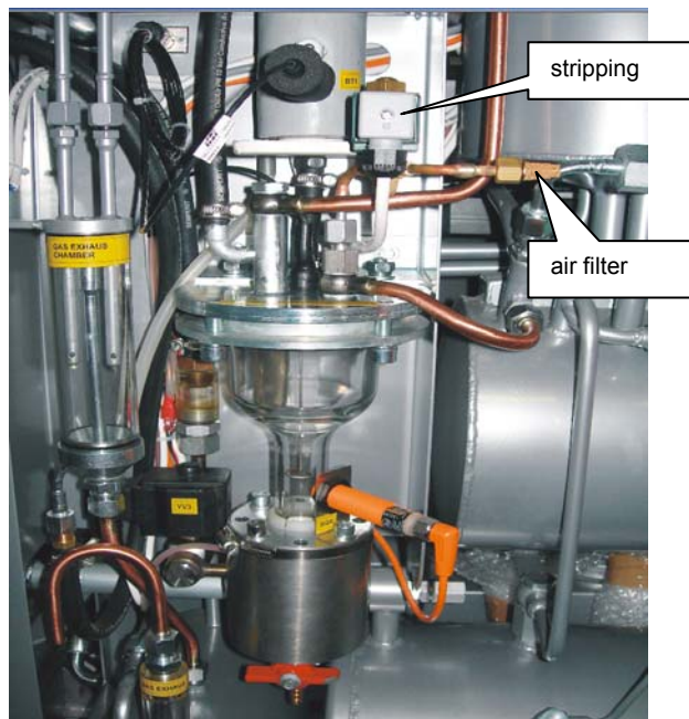
Vnitřní uspořádání Vakuového separátoru VS-06 (verze 2018) Stripping : odstraňování rozkladných plynů
